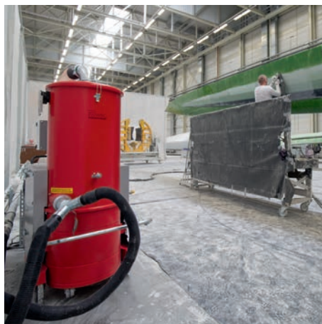
Aufsaugen von GFK-Staub in der Rotor- blattproduktion
