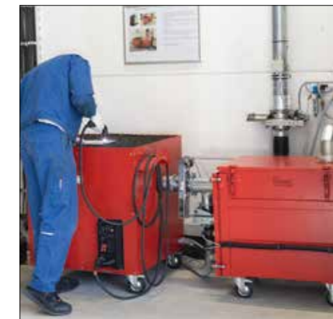
NA 250 Stahlblech ohne Reststaubfilter beim Plasmaschneiden
