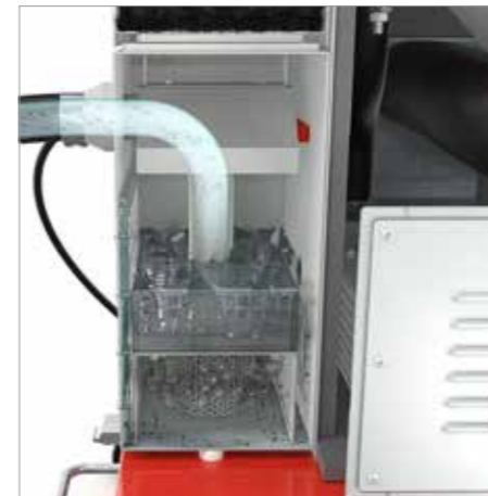
Einsaugen reaktiver Partikel
